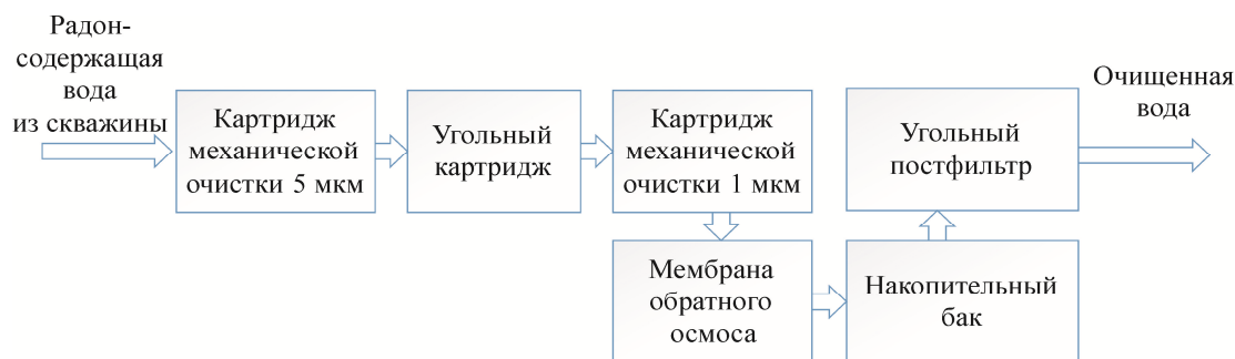
Рис. 2. Блок-схема очистки природной воды от радона мембраной фильтрацией
