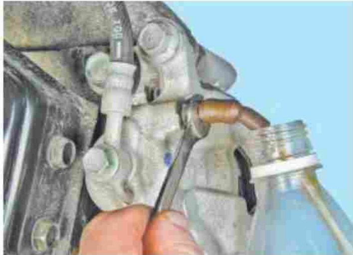
Рисунок 24–Стравливание воздуха из клапана
