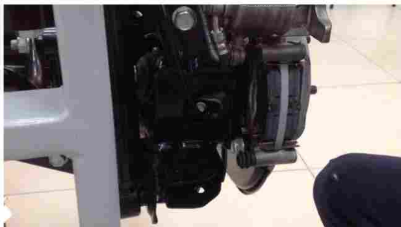
Рисунок 13 – Поднятие подвижной скобы вверх
