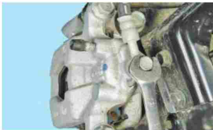
Рисунок 6 – Отведение подвижной скобы наружу
