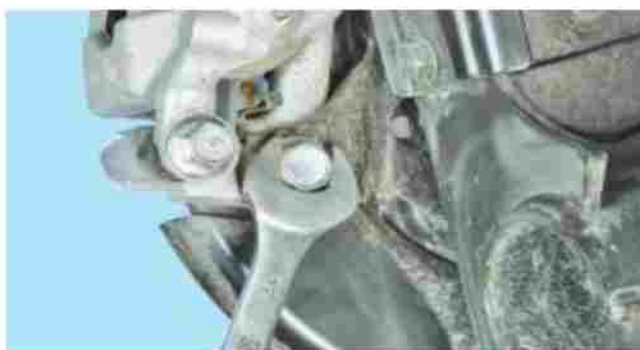
Рисунок 8 – Крепление направляющей колодок к балке
