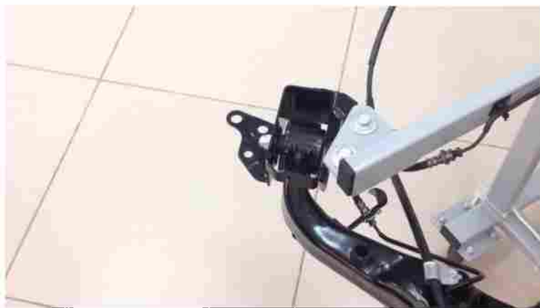
Рисунок 2 – Крепление балки задней подвески к кронштейну
