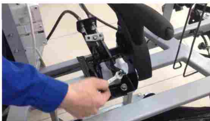
Рисунок–31 - Затяжка регулировочной гайки
