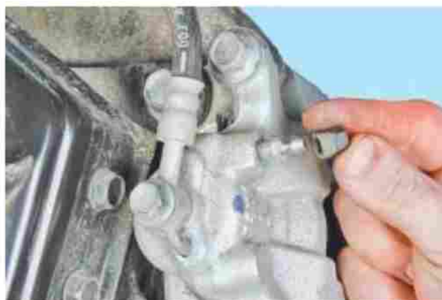
Рисунок 22 – Снятие защитного колпачка клапана
