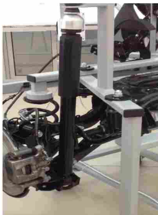
Рисунок 3 – Проверка состояния амортизатора
