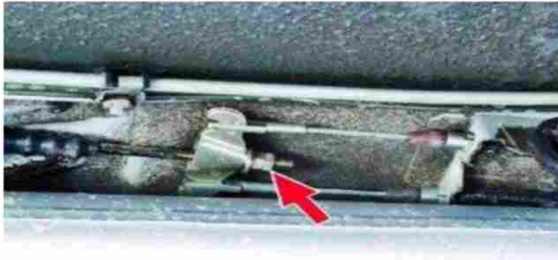
Рисунок–28 - Месторасположение регулировочной гайки стояночного тормоза автомобиля ВАЗ 2109.
