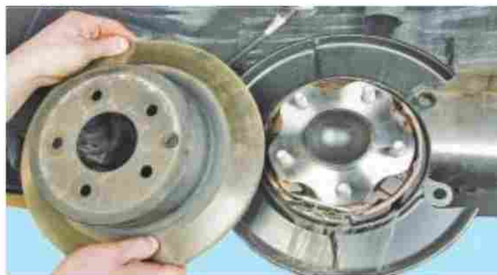
Рисунок 10 – Снятие тормозного диска
