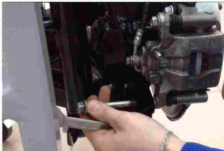
Рисунок 12 – Извлечение направляющего пальца подвижной скобы
