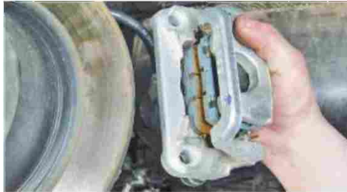
Рисунок 9 – Снятие подвижной скобы
