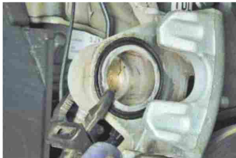
Рисунок 16 – Перемещение поршня рабочего цилиндра
