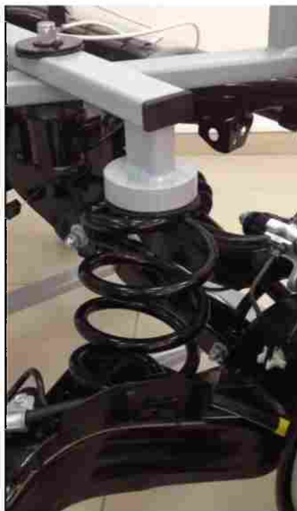
Рисунок 4 – Проверка состояния пружины задней подвески
