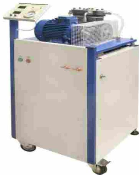
Рисунок 21 - ЛС «Компрессор автомобиля с пневматическим приводом тормозов»
