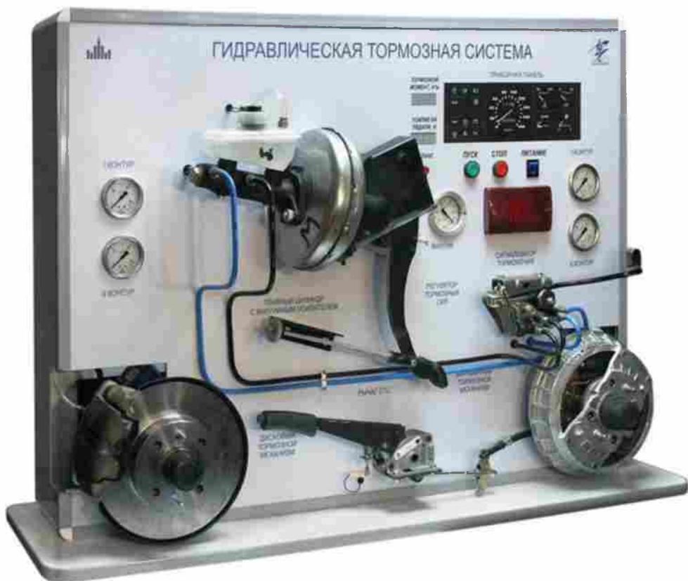
Рисунок 22 - ЛС «Гидравлическая тормозная система автомобиля IV»
