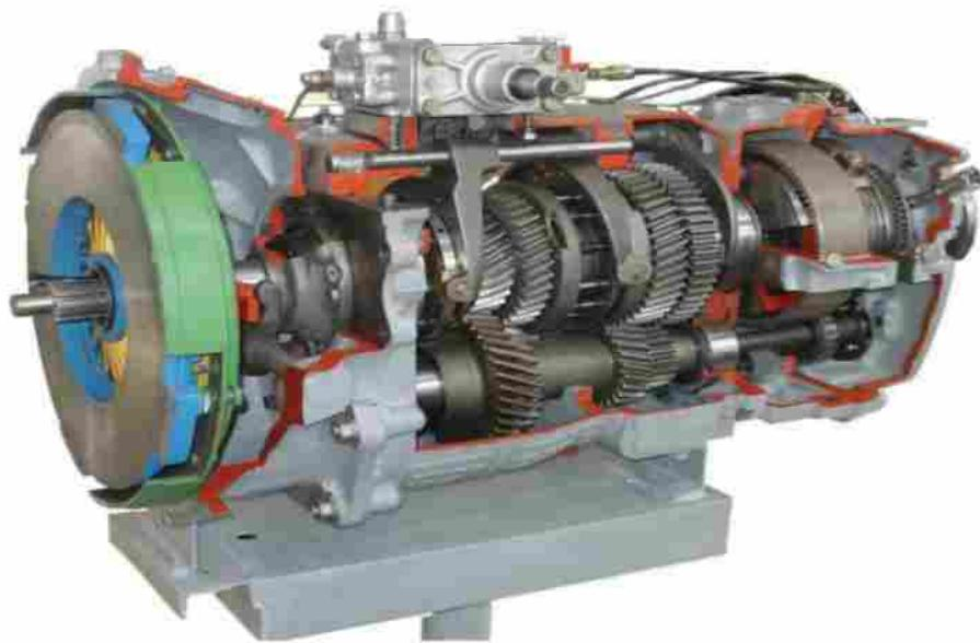
Рисунок 15 - Коробка передач с демультиплликатором (КАМАЗ)
