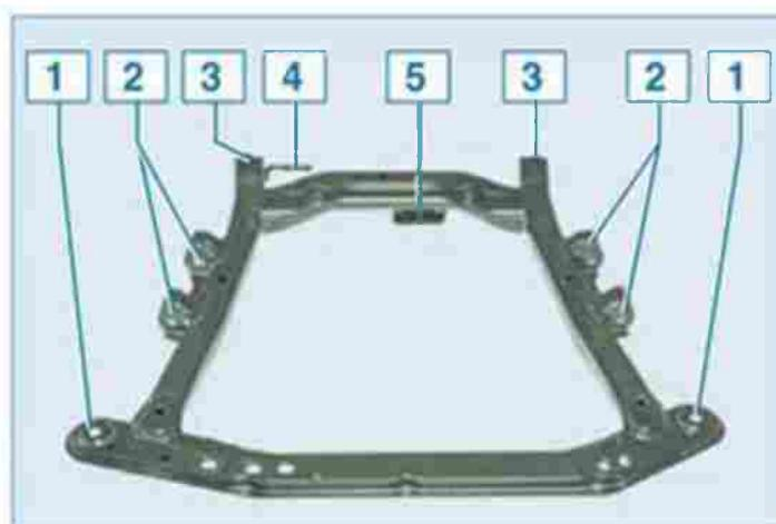
Рисунок 35 - Подрамник: 1 - точки переднего крепления подрамника к кузову; 2 - точки крепления рычага подвески к подрамнику; 3 - точки заднего крепления подрамника и стабилизатора поперечной устойчивости; 4 - кронштейн подвески системы выпуска отработавших газов (не используется); 5 - кронштейн крепления задней опоры силового агрегата.
