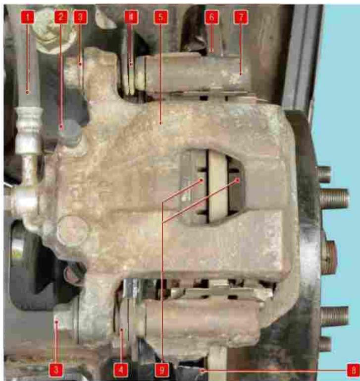
Рисунок 44 - Тормозной механизм заднего колеса: 1 – тормозной шланг; 2 – клапан выпуска воздуха; 3 – направляющие пальцы суппорта; 4 – пыльник направляющего пальца; 5 – суппорт тормозного механизма; 6 – тормозной диск; 7 – направляющая колодка; 8 – щит тормозного механизма; 9 – тормозные колодки.
