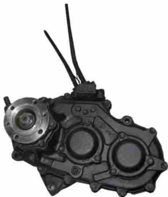
Рисунок 12 – «Раздаточная коробка автомобиля УАЗ».
