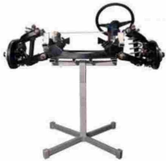
Рисунок 20 - Передняя подвеска заднеприводного автомобиля в сборе с рулевым и тормозными механизмами
