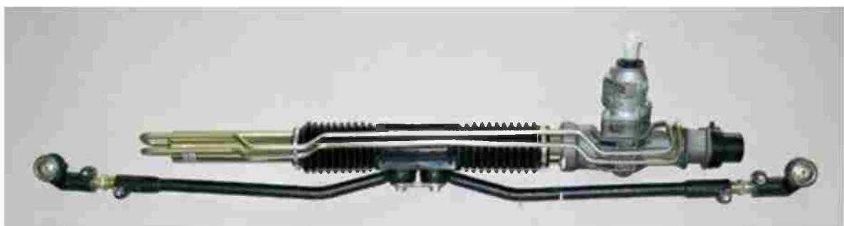
Рисунок 23 - Реечный рулевой механизм с ГУР
