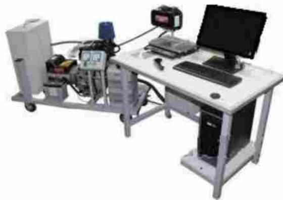
Рисунок 4 – Автоматизированный лабораторный комплекс «Рабочие процессы бензиновых двигателей с мотор-генераторной нагрузжающей установкой»
