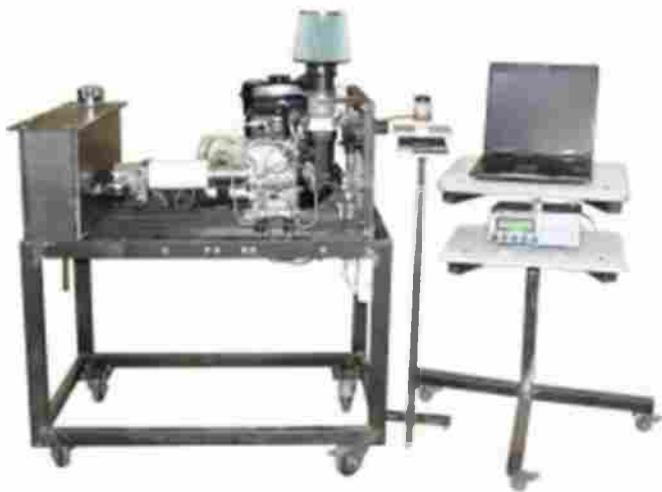
Рисунок 5 - Автоматизированный лабораторный стенд «Рабочие процессы бензиновых двигателей внутреннего сгорания с электронным нагружающим устройством»
