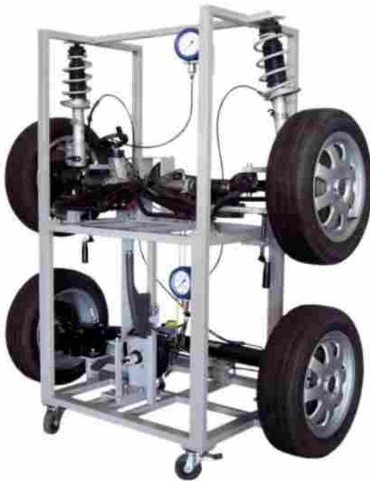
Рисунок 17 - Учебный стенд FLB Ходовая часть автомобиля с системой рулевого управления и с тормозной системой
