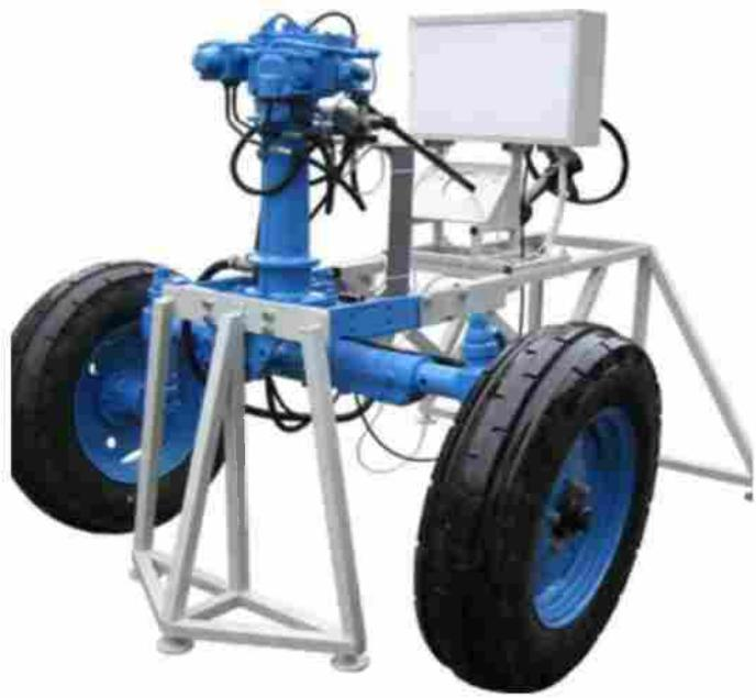
Рисунок 24 - Рулевое управление трактора с гидроусилителем интегрального типа НТЦ-15.39.1.
