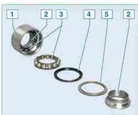
Рисунок 40 - Устройство двухрядного подшипника ступицы (для наглядности элементы одного ряда извлечены из наружного кольца подшипника): 1 - наружное кольцо подшипника; 2 - внутреннее кольцо подшипника; 3 - сепаратор с шариками; 4 - сальник; 5 - защитная шайба.
