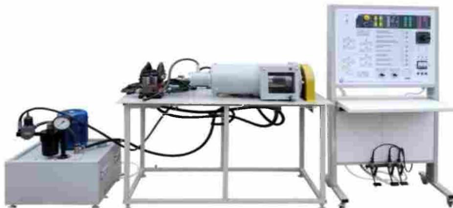
Рисунок 10 Комплексная электронная система управления трансмиссией трактора Белорус
