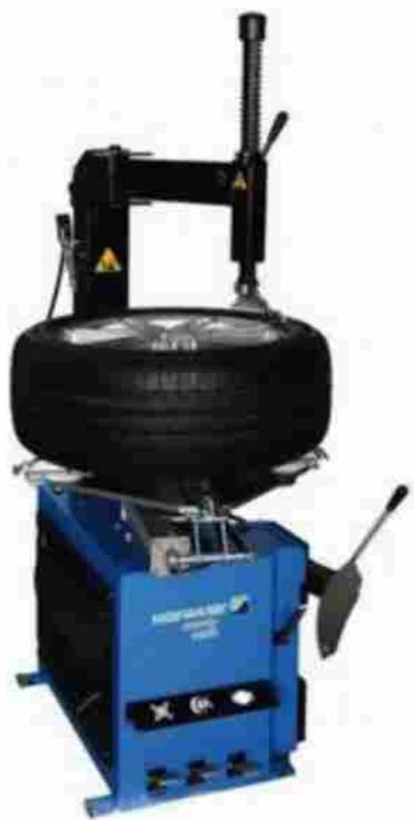
Рисунок 18 - Стенд-тренажер «Шиномонтажные работы легковых автомобилей»
