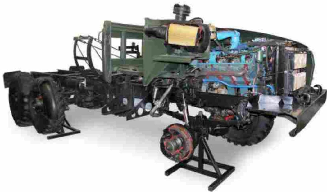
Рисунок 3 – Разрезной грузовой автомобиль – тренажер
