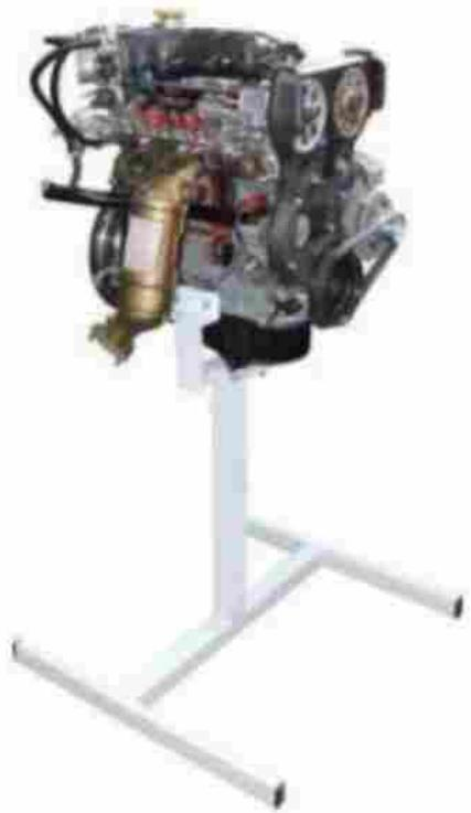
Рисунок 9 - Двигатель переднеприводного автомобиля (ДОHC, 16-кл.) в сборе со сцеплением и коробкой передач (агрегаты в разрезе) с электромеханическим приводом
