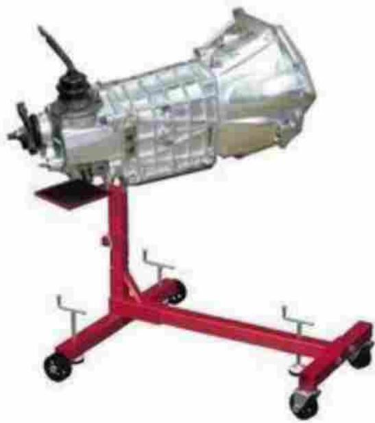
Рисунок 13- Стенд-тренажер «Коробка передач ВАЗ 2101-07»
