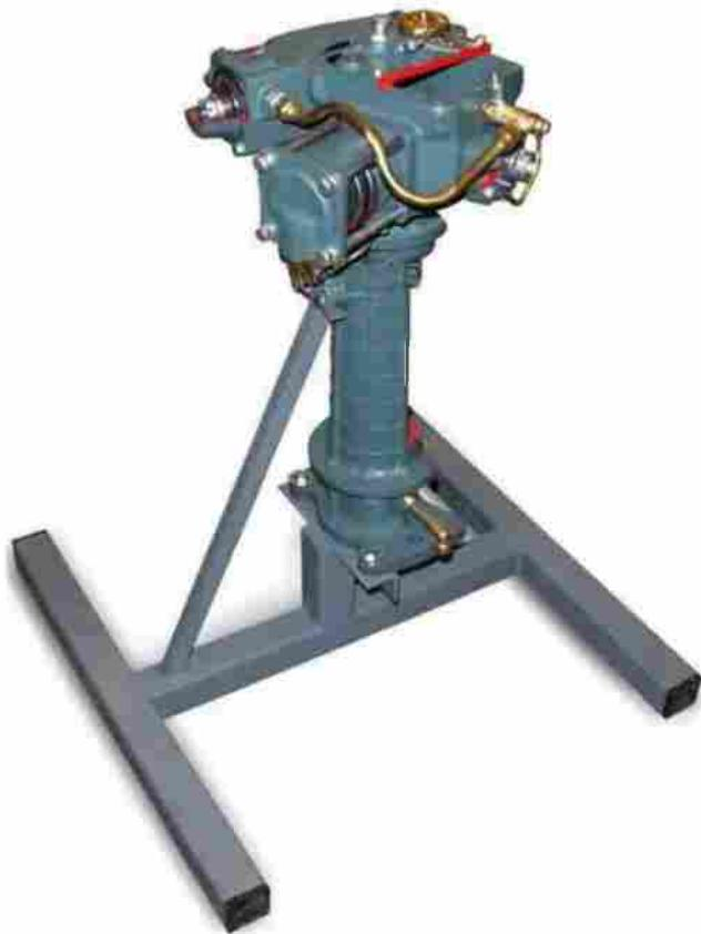
Рисунок 26 - Разрезные элементы. Рулевой механизм трактора МТЗ
