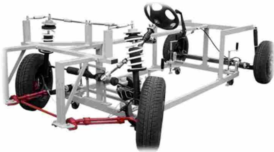
Рисунок 16 - Учебный лабораторный комплекс AMBS геометрии оригинальной ходовой части легкового автомобиля Opel Corsa
