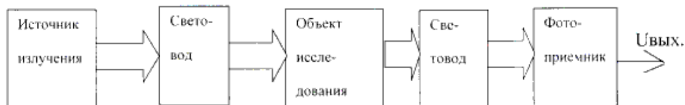
Рисунок 3.3- Структурная схема волоконно-оптического преобразователя.
