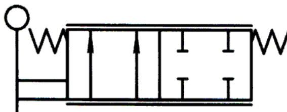
Рисунок 3.3 – Гидравлическая схема двухпозиционного дросселирующего распределителя механического управления от рычага
