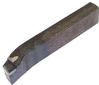
Рисунок 2.3.1(б) - Резец подрезной
