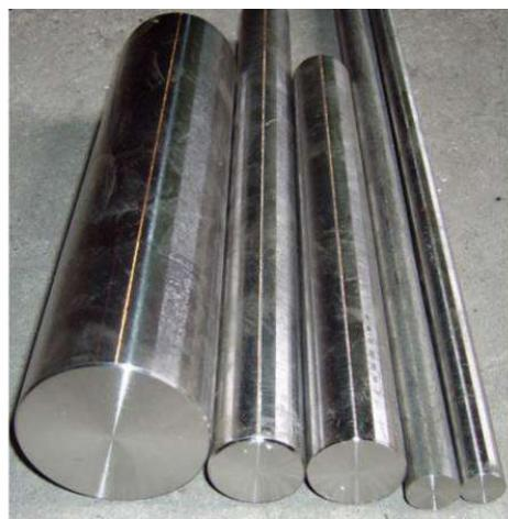
Рисунок 2.2.1 – Пруток стальной Сталь 45
