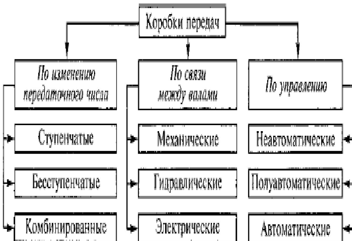
Рисунок 1.1.1 – Классификация коробок передач[15]
