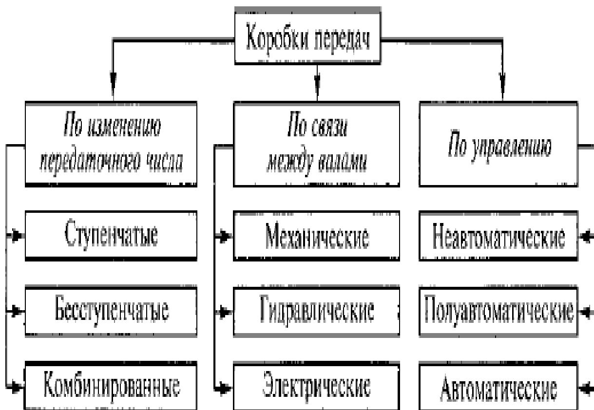
Рисунок 1.1.1 – Классификация коробок передач[15]
