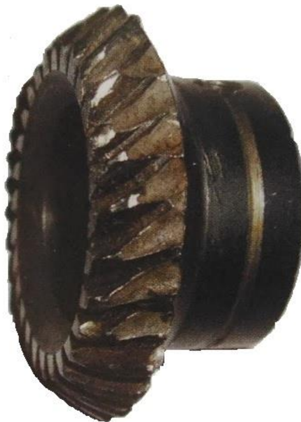
Рисунок 2.8 – Изношенное коническое колесо со сколами вершин зубьев
