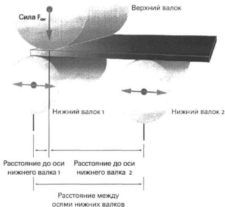
Рисунок 4. Валки листогибочной машины
