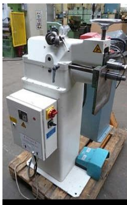
Рисунок 12 - Кромкогибочная машина FASTI 416-63-1,5
