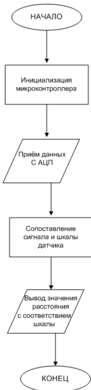
Рисунок А.1 – Блок-схема работы датчика уровня
