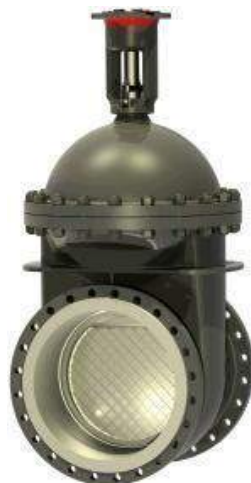
Рисунок 2.15 – Задвижка стальная 30с927нж под электропривод, 30с527нж с редуктором Ру25 клиновья фланцевая (под приварку)
