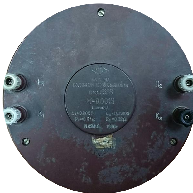
Рисунок 2.4 – Катушка взаимной индуктивности P536
