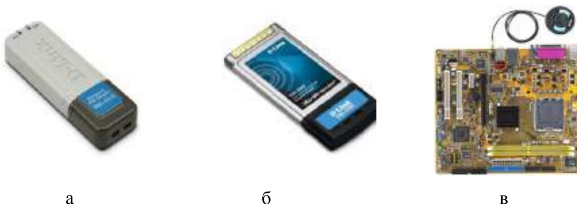
а б в Рисунок 1.6 - Беспроводные адаптеры: а - с USB портом, б - формата PCMCIA, в – встраиваемый
