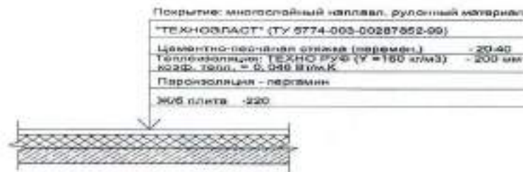
Рис.1.2. Расчетная конструкция перекрытия.
