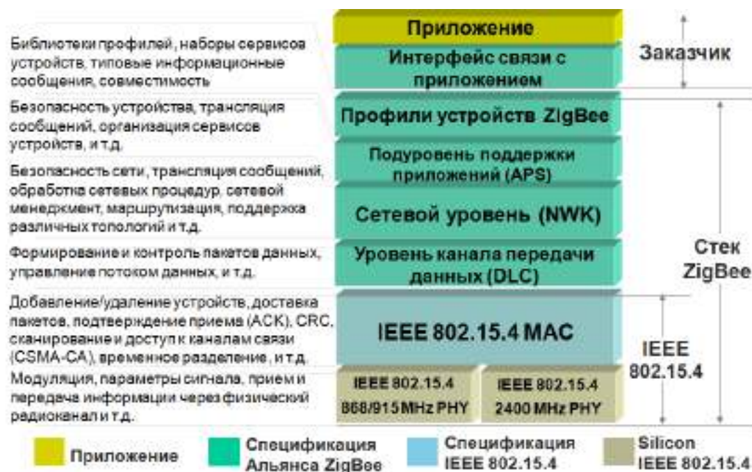
Рисунок 2.9 – Конфигурация стека протокола ZigBee
