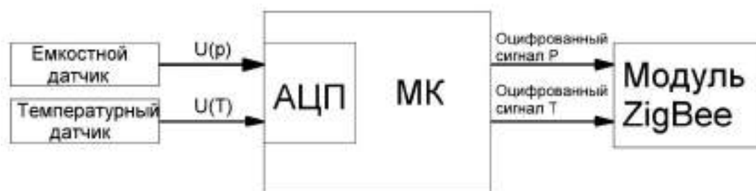
Рисунке 2.1 – Функциональная схема цифрового датчика давления
