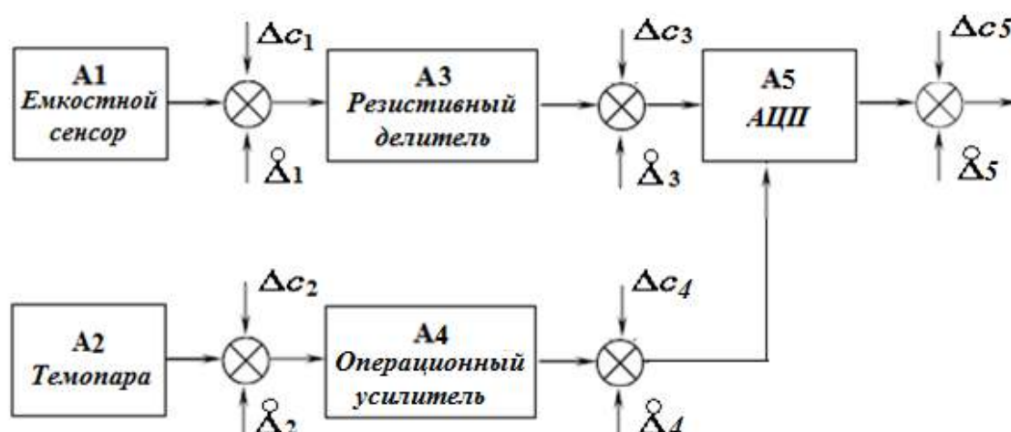
Рисунок 4.1 – Измерительный канал датчика давления
