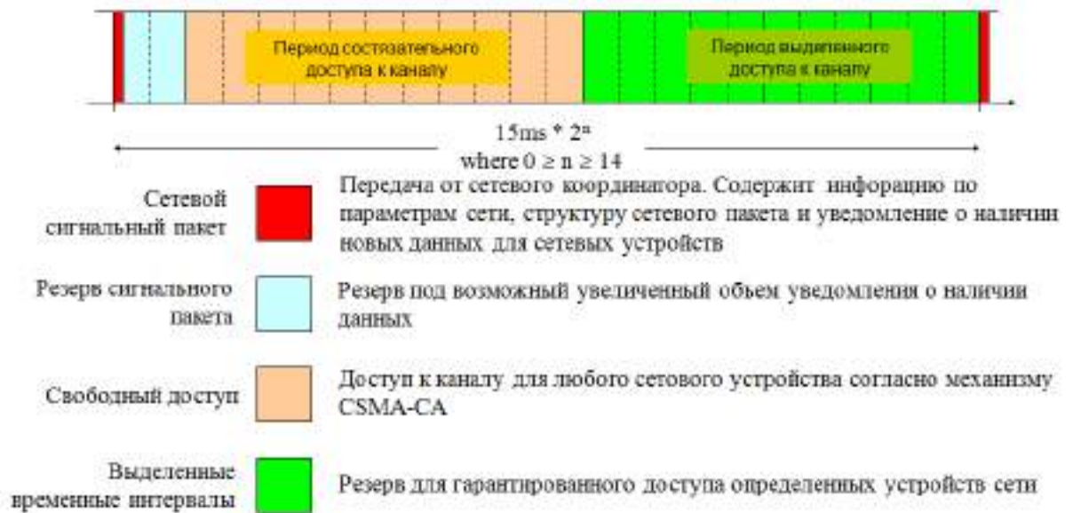
Рисунок 2.11 – Синхронизированный доступ в сеть ZigBee
