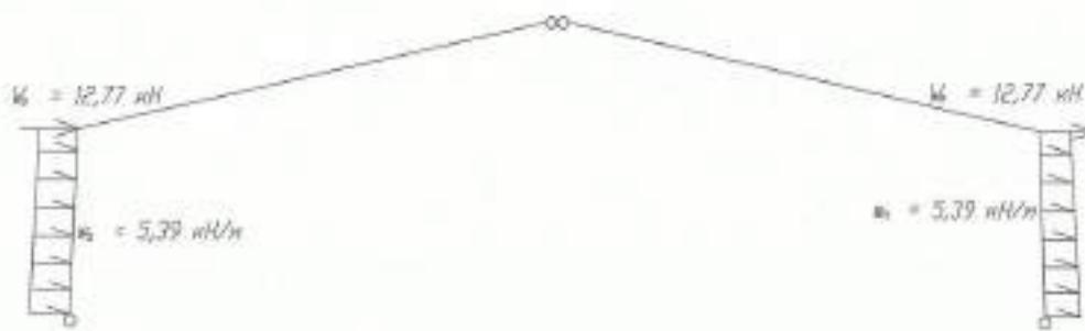
Рисунок 2.9 Схема загружения рамы ветровой нагрузкой
