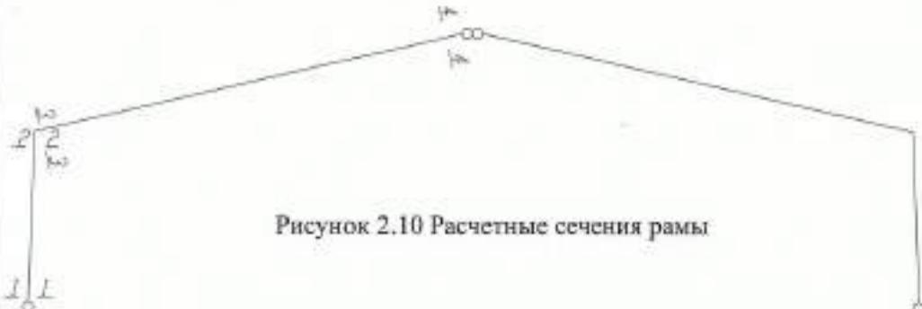
Рисунок 2.10 Расчетные сечения рамы
