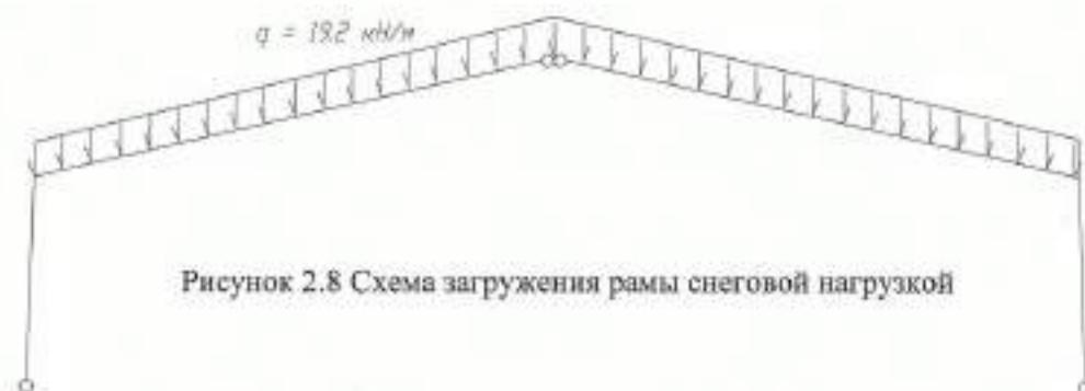
Рисунок 2.8 Схема загружения рамы снеговой нагрузкой
