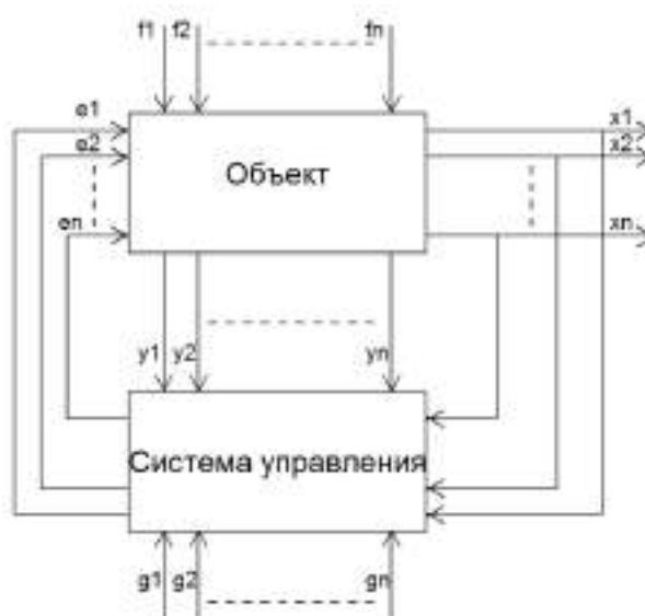
Рисунок 1.4 – Структурная схема системы автоматизации
