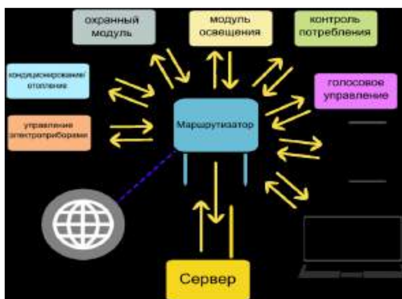
Рисунок 1.2 – Принцип построения системы “умный дом” с беспроводным маршрутизатором или модемом
