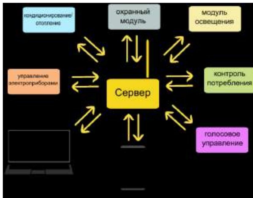
Рисунок 1.3 – Принцип построения системы “умный дом” с сервером в режиме soft AP
