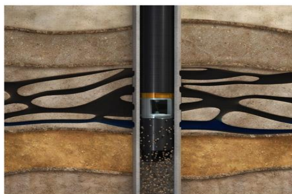
г) Сжатие и охлаждение плазмы приводит к выносу закупоривающих осадков в ствол скважины, а ударная волна переходит в объемную упругую волну
