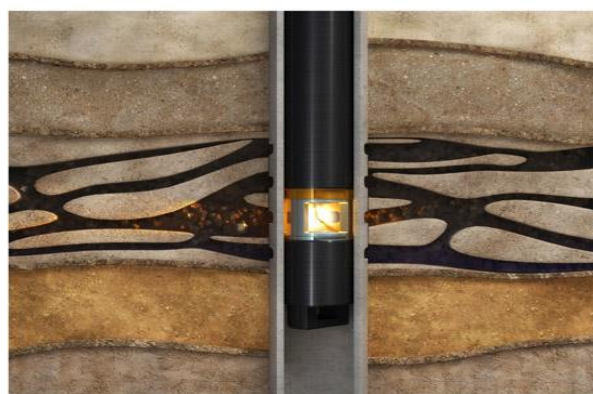
б) Иницируется взрыв проводника, происходит образование плазмы
