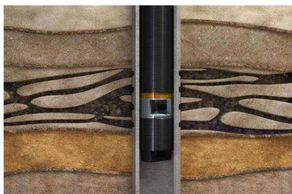
а) Электроды замкнуты проводником, перфорационные каналы закольматированы
