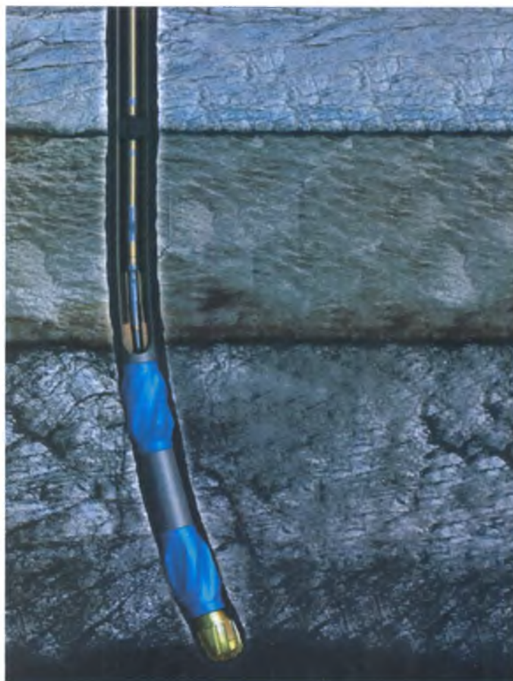
Рисунок 3.1 – Телеметрическая система СИБ-2 в процессе бурения
