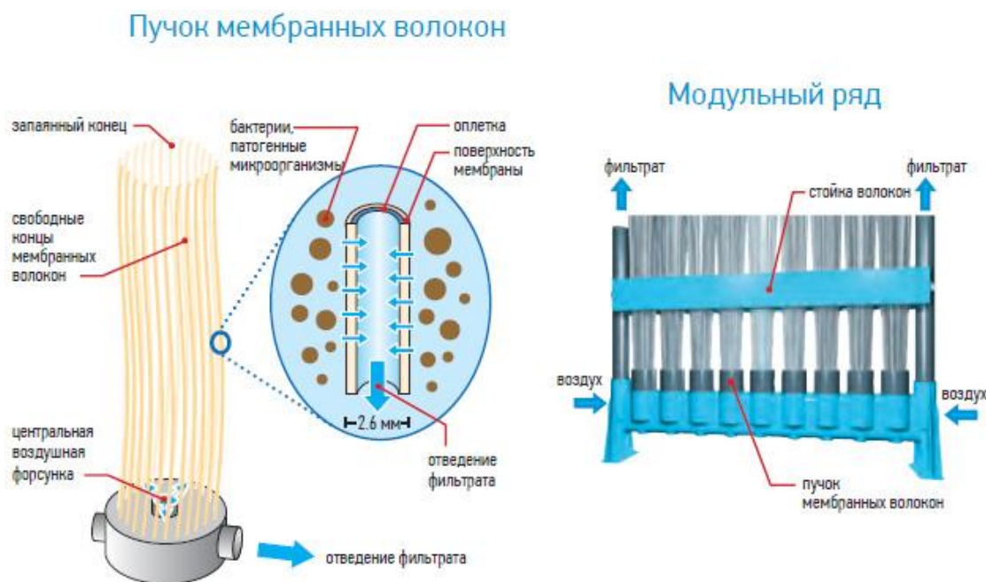
Рис. 9 – Устройство мембранного модуля.
