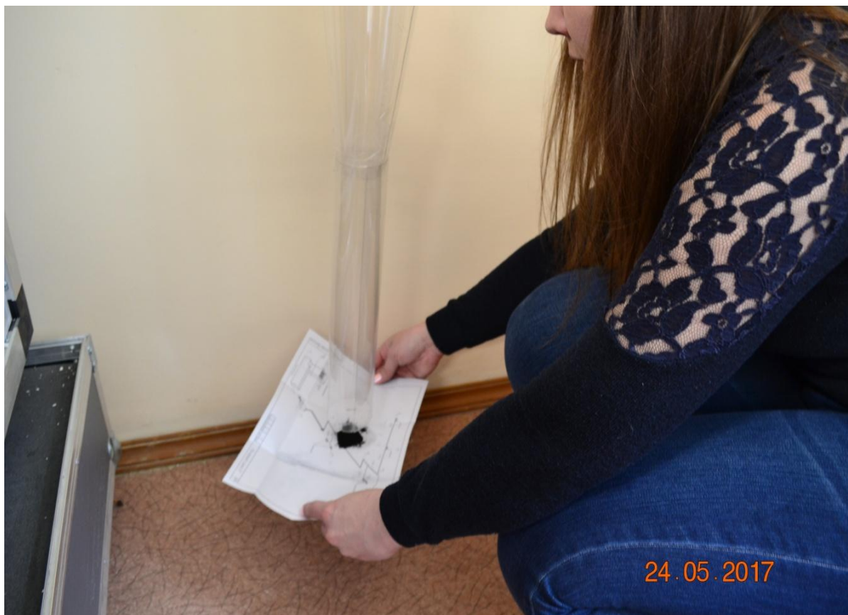
Рисунок 2.9– Помещение частиц помола нефтяного кокса в коллектор экспериментальной установки.
