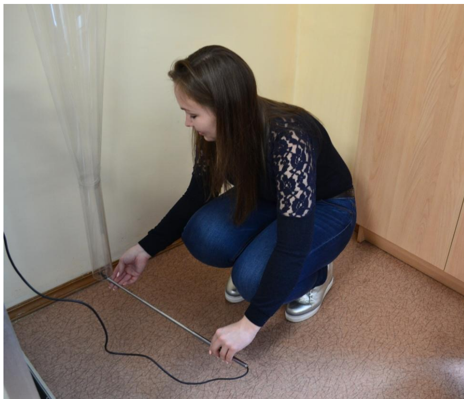
Рисунок 2.11 – Измерение скорости во всасывающем патрубке экспериментальной установки с помощью термоанемометра «Актаком» АТТ-1004.
