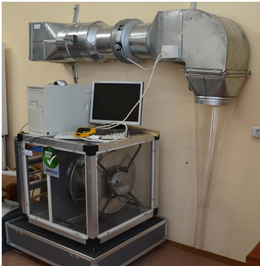
Рисунок 2.8 – Фотография экспериментальной установки по определению скорости витания частиц помола нефтяного кокса.
