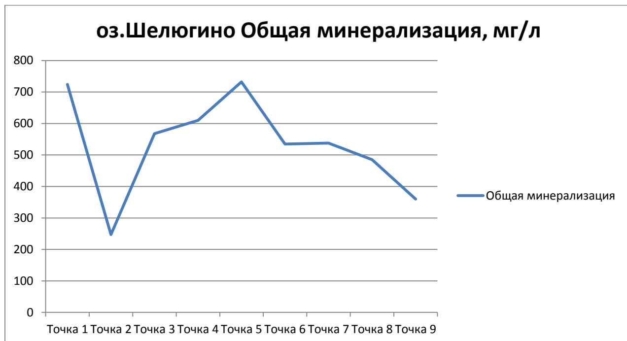
Рисунок 5.30 – График изменения общей минерализации в оз.Шелюгино Из графика мы видим, что общая минерализация изменяется от 724 до 360, минимальное значение общей минерализации в точке 2 – 247.
