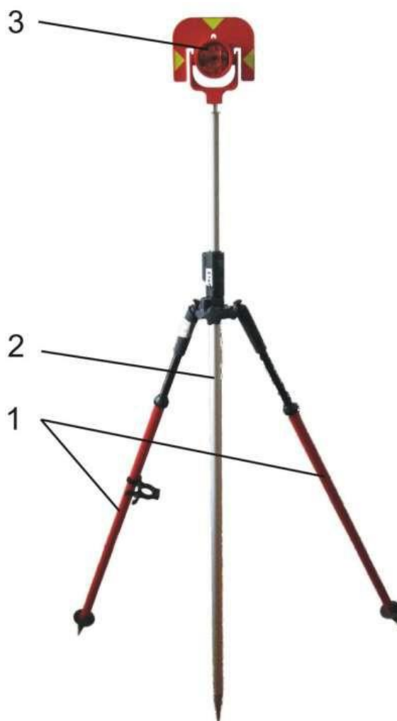
Рисунок 4 – Веха GLS11 с отражателем, установленная в биподе GSR111:
