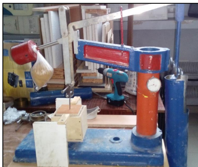
Рисунок 9 – Фиксирование формы опалубки в приборе Михаэлиса
