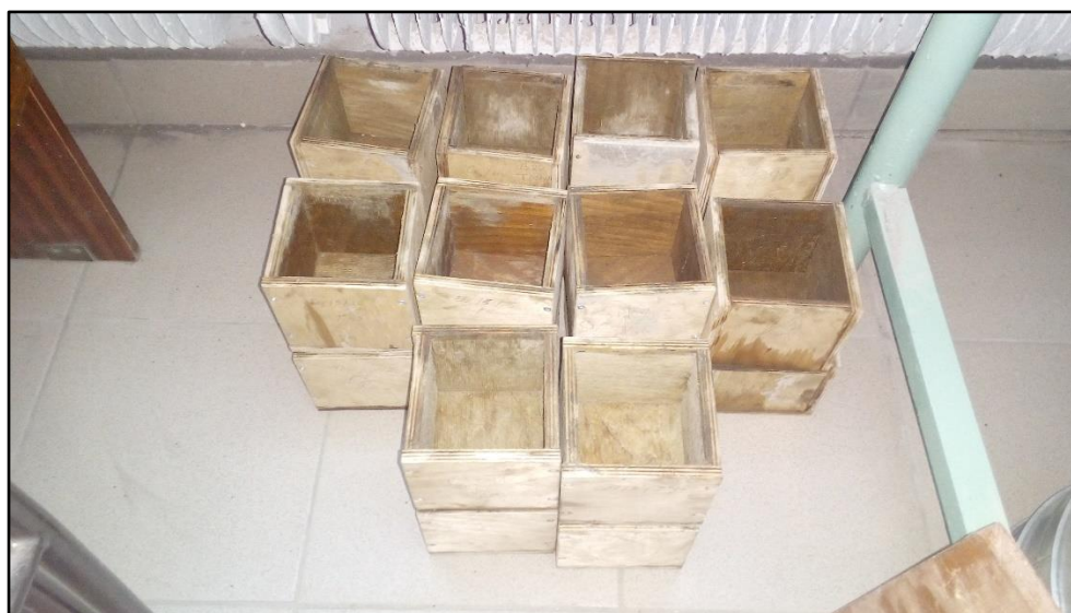
Рисунок 13 – Подготовка деревянных форм
