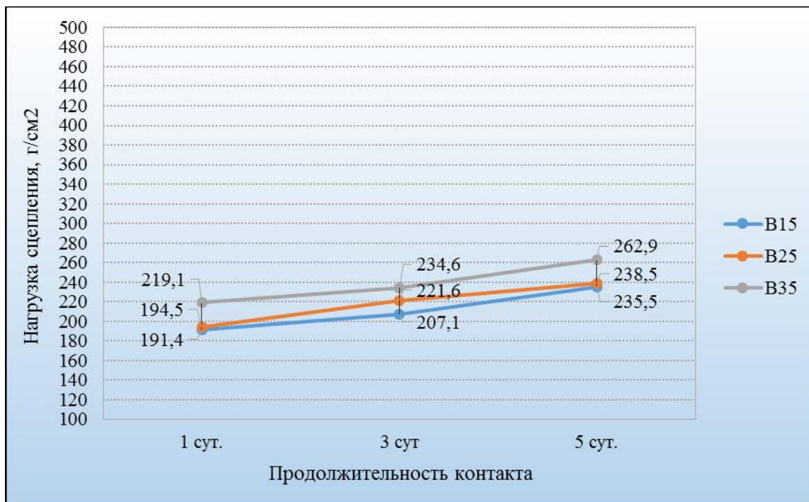
График 3 – Зависимость значения нагрузки сцепления от используемого бетона (опалубка – ламинированная фанера)
