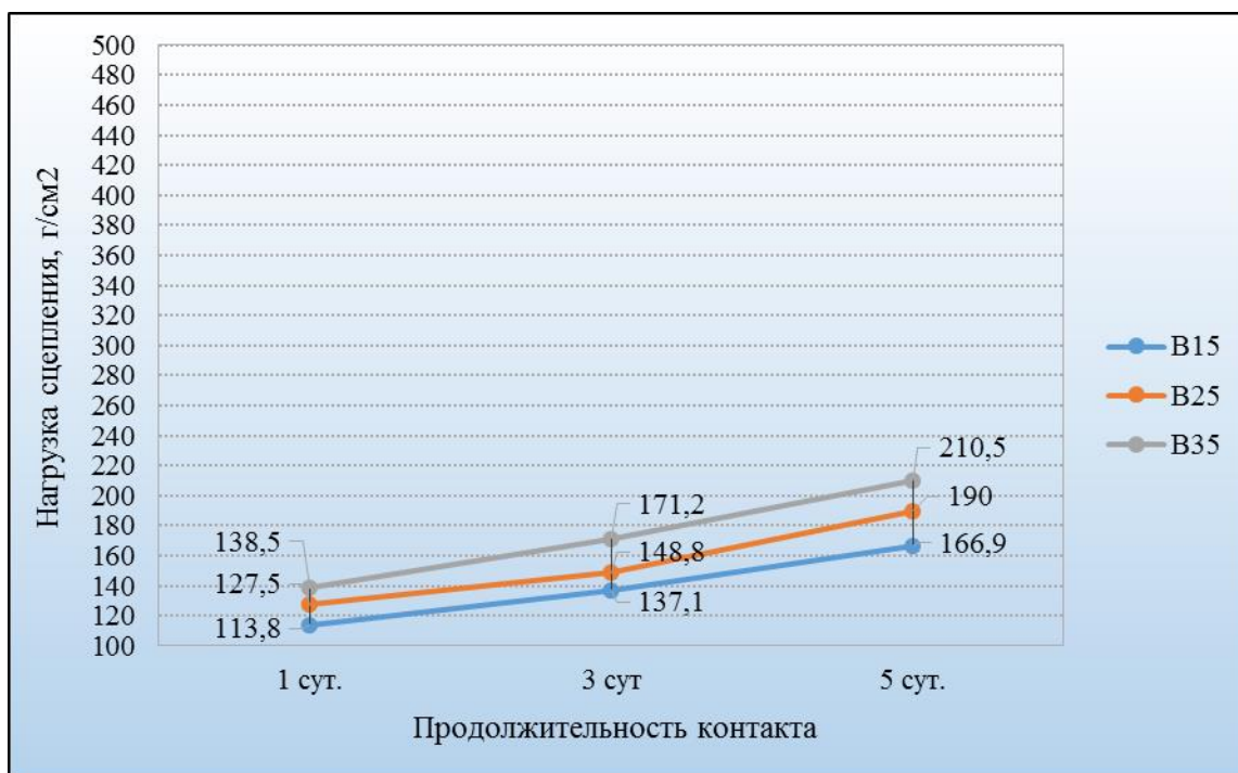
График 4 – Зависимость значения нагрузки сцепления от используемого бетона (опалубка – текстолит)
