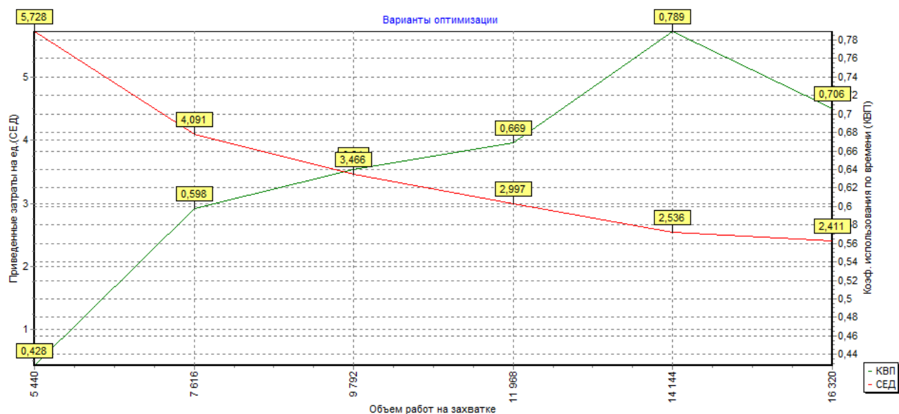
Рис. 10.6. Зависимость приведенных затрат и коэффициента взаимодействия машин в потоке от сменного объема работ для отряда №6 (устройство поверхностной обработки, ведущая машина – распределитель каменной мелочи)
