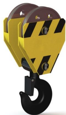
Рисунок 1.10 - Крюковой захват при использовании сдвоенных полиспастов
