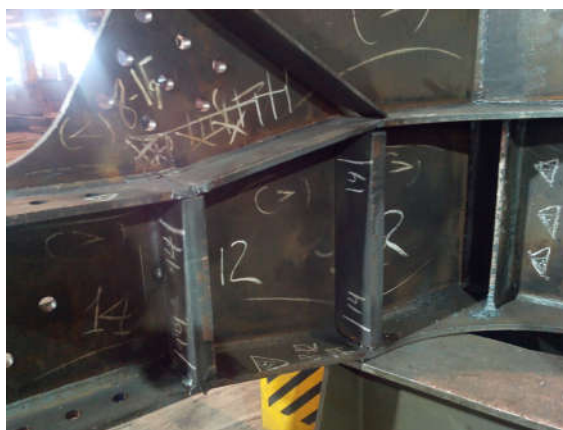
Рисунок 1.5 Перелом поясов с целью увеличения высоты сечения
