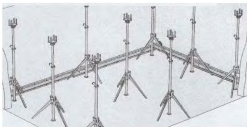
Рисунок 3.1.3 Общий вид помещения после монтажа основных стоек
