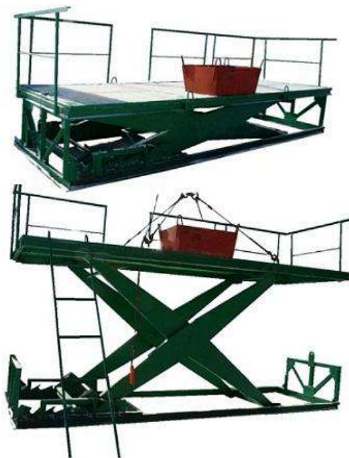
Рис.31.Рычажно-подъёмные подмости для кирпичной кладки
