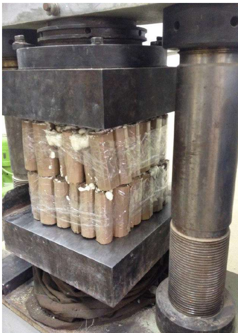
Рис.72 – Установка образца №2 между плитами
