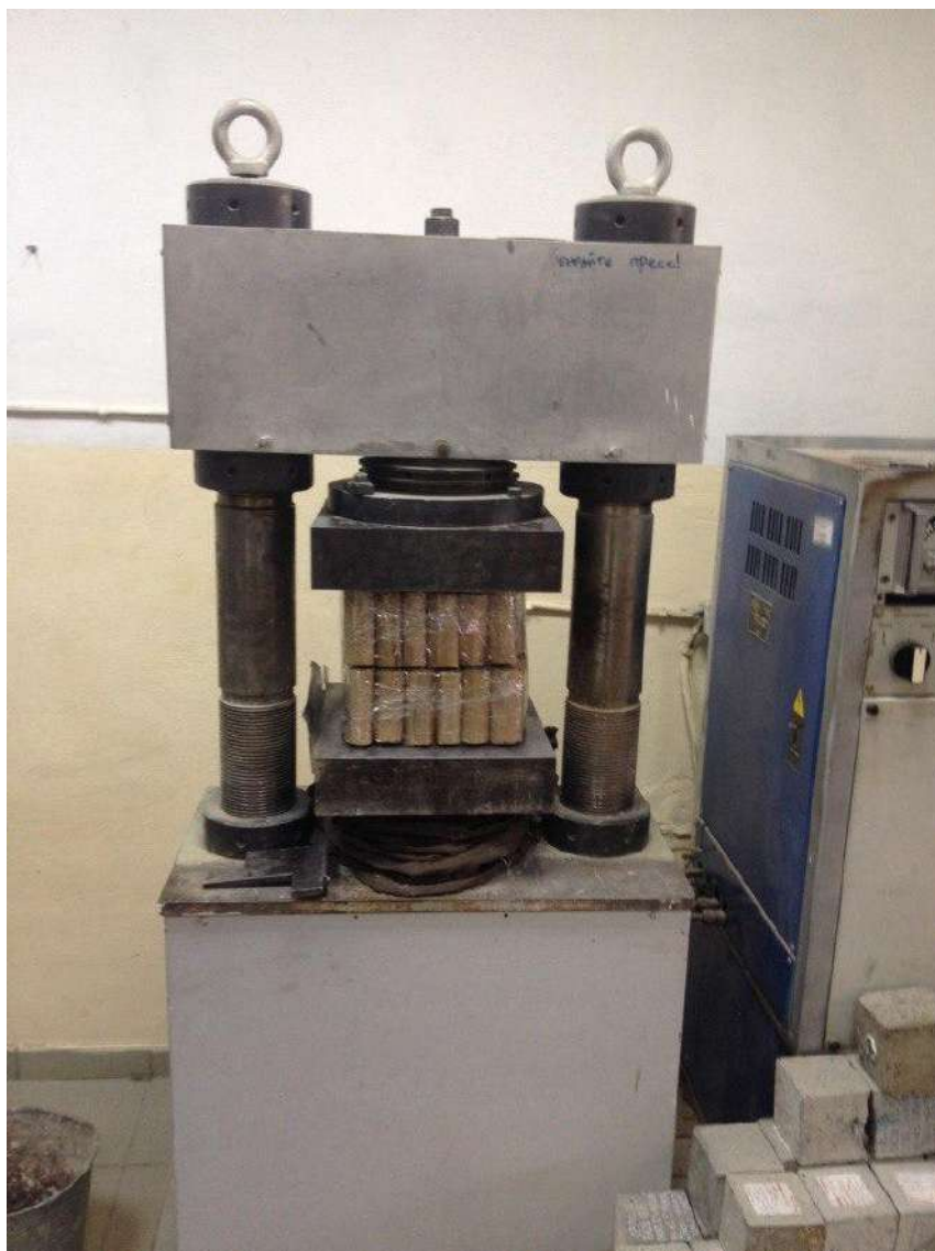
Рис.69 – Установка образца №1 между плитами
