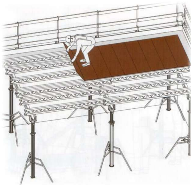
Рис. 3.7. Укладка листов фанеры
