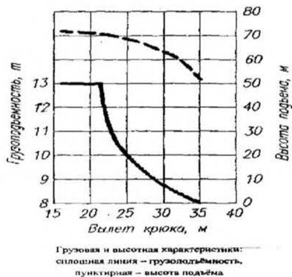
Рисунок 4.1: Схема выбора крана
