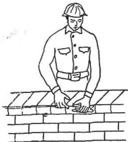
Рис. 3.5 Натягивание причального шнура на уровне верха укладываемых кирпичей
