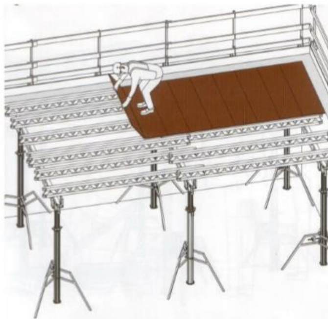
Рис. 3.22 Укладка листов фанеры
