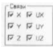
Рис. 2.1 – Связи, наложенные на узлы несущих стен, диафрагм жёсткости.
