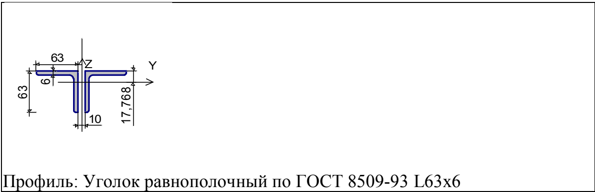
Рис.16 Сечение нижнего пояса по второй схеме загрузки
