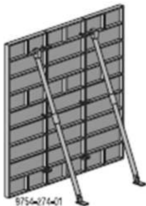
Рис. 5.4. Схема установки щитов опалубки.
