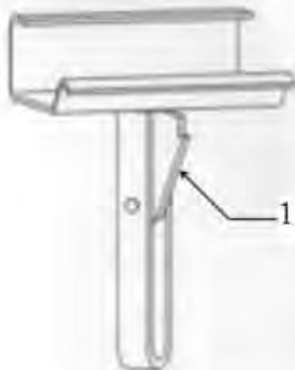
Рисунок 3.4.6 Головка-захват
