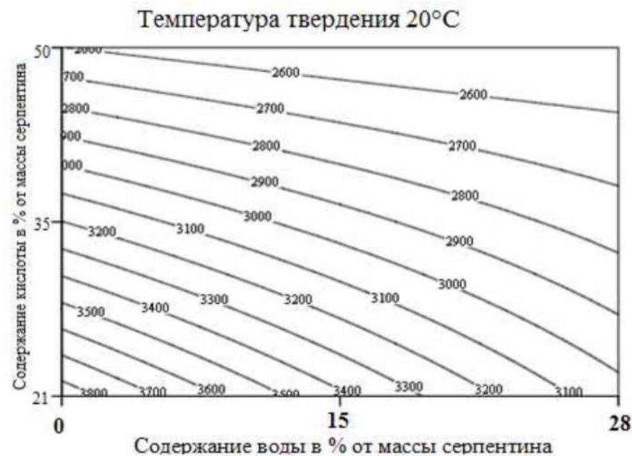
Рисунок 4.3 – Время протекания реакции при температуре твердения 20°C, минут
