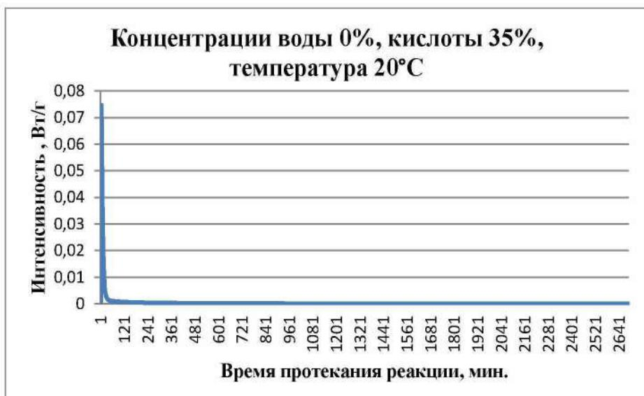
Рисунок 4.1 – Микрокалориметрия для образца с концентрациями воды 0%,
