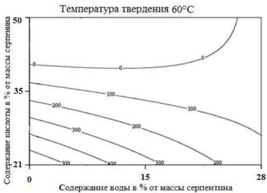
Рисунок 4.5 – Время протекания реакции при температуре твердения 60°C, минут
