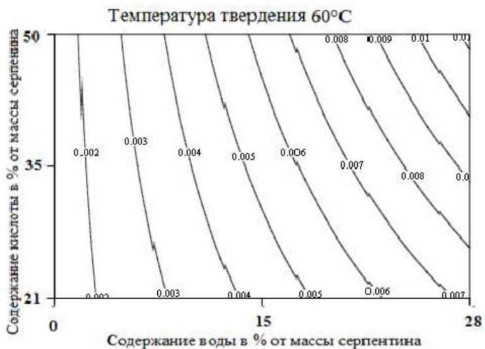
Рисунок 4.9 – Интенсивность протекания реакции при температуре твердения 60°C, Вт/г
