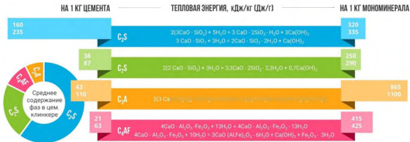
Рисунок 1 – Реакции гидратации минералов клинкера и их тепловая энергия
