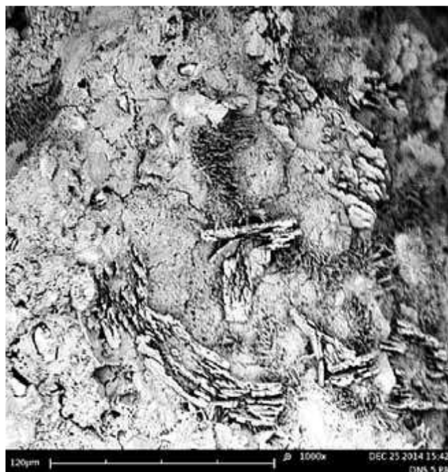
Рисунок 10 – Микроструктура цементного камня с добавкой дисперсии микрокремнезема (5 % от массы портландцемента)
