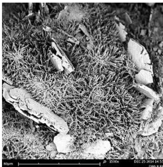
Рисунок 11 – Микроструктура с добавкой с добавкой дисперсии микрокремнезема (8 % от массы портландцемента)
