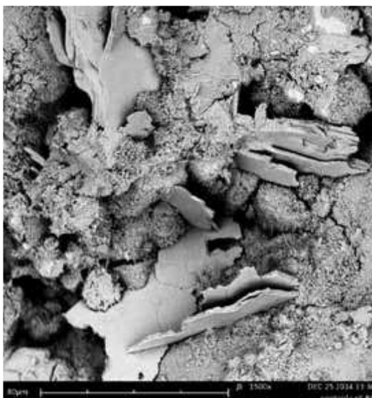
Рисунок 7 – Макроструктура цементной матрицы с кристаллами гидроксида кальция (при 1500-кратномувеличении)
