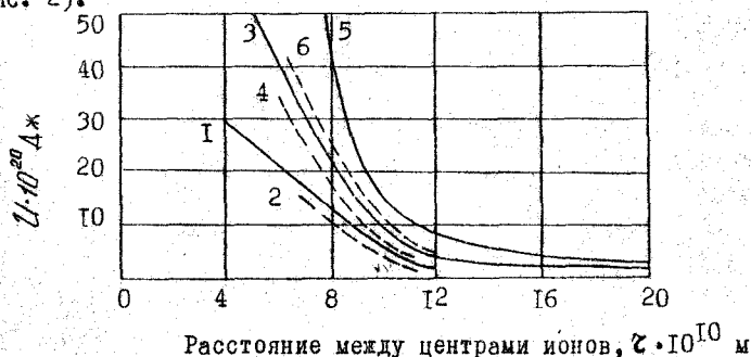
Рис. 2. Соотношение между действительной энергией притяжения ионов в растворе (—) и необходимой для их дальнейшего сближения (---); 1 и 2 — ионы \text{CaOH}^+ и \text{OH}^- , 3 и 4 — ионы \text{CaOH}^+ и \text{SiO}_4^{2-} , 5 и 6 — ионы \text{Ca}^{2+} и \text{SiO}_4^{2-}
