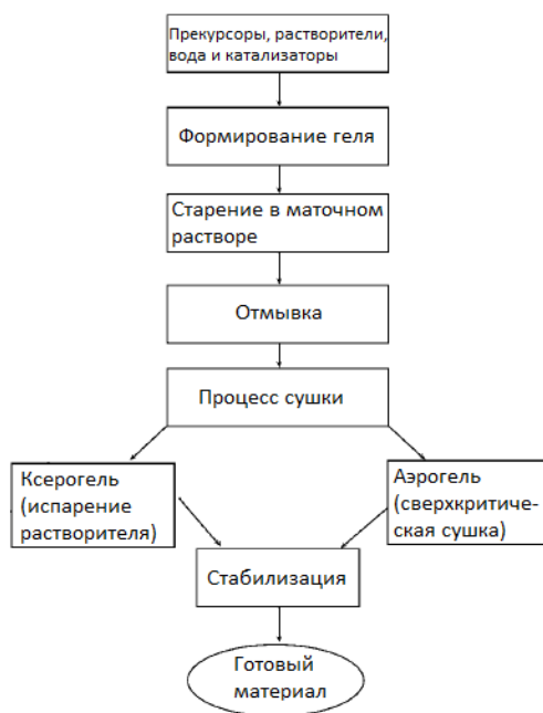
Рисунок 1.20 – Последовательность стадий синтеза пористых твердых материалов золь-гель методом
