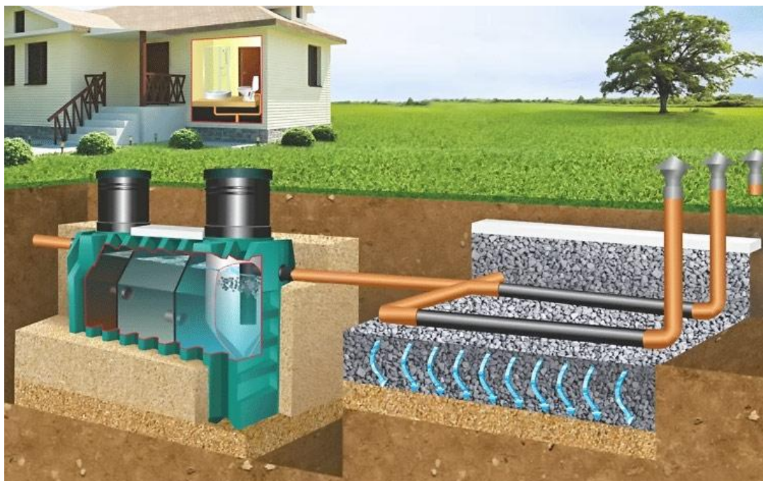
Рисунок 1.5 – Монтаж септик и поле фильтрации [18]
