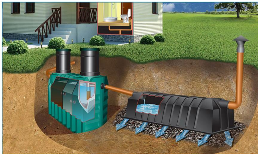
Рисунок 1.4 – Монтаж септик и инфильтратор [18]
