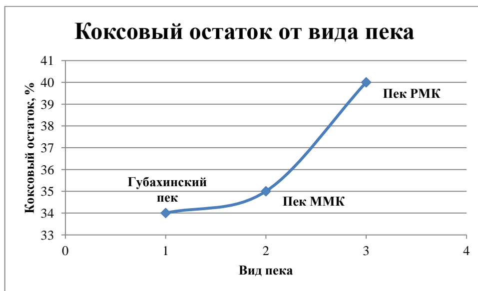
Рисунок 3.3 – Зависимость выхода коксового остатка от вида пека
