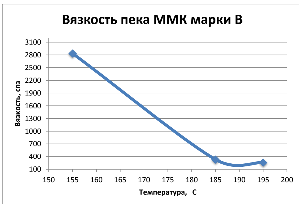
Рисунок 19 – Зависимость вязкости пека ММК марки В от температуры
