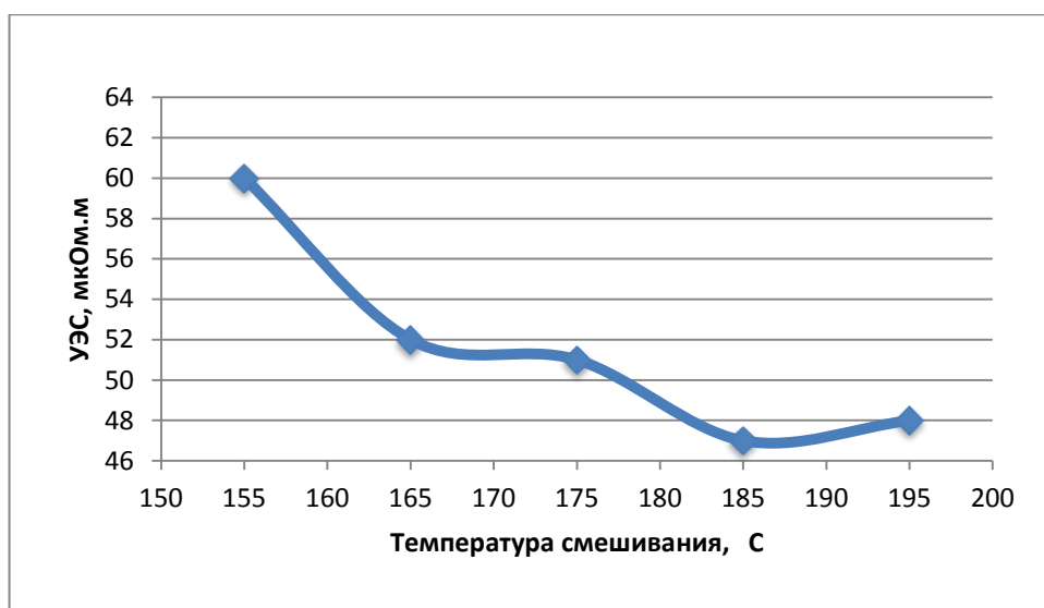
Рисунок 22 – Зависимость УЭС обожженных анодов от температуры смешивания
