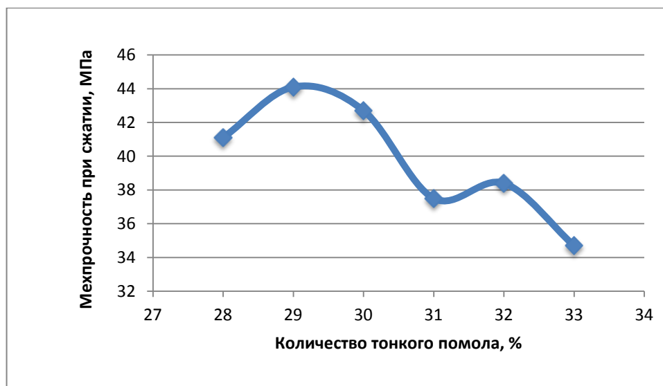
Рисунок 16 – Зависимость механической прочности при сжатии обожженных анодов от количества тонкого помола в массе
