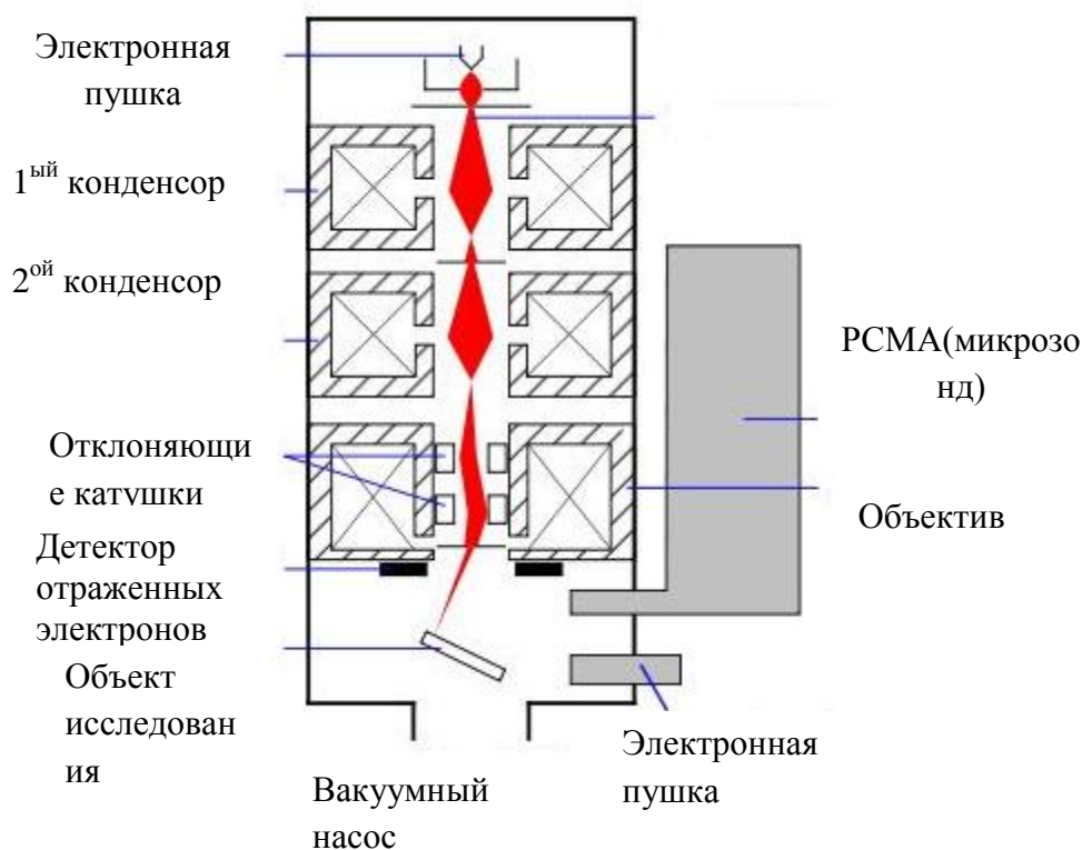
Рисунок 4 – Схема РЭМ с детектором рентгеновских лучей – микрозондом
