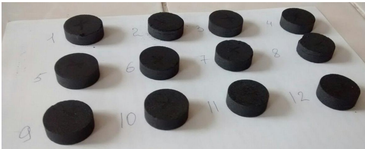
Рисунок 14 – Таблетки, состоящие из смеси «ФФС – графит» после термообработки при 200 °С, предназначенные для испытания
