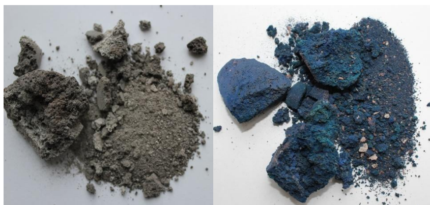
Рисунок 4.8 – фотографии образцов, показывающие влияние температурного режима на окраску
