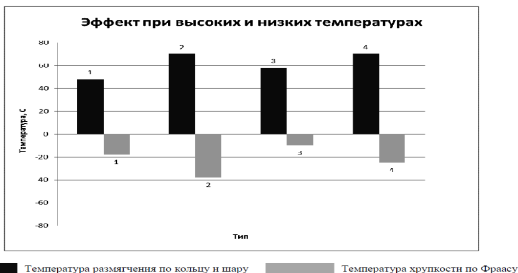
Рисунок 1 – Изменение температуры размягчения и хрупкости.
