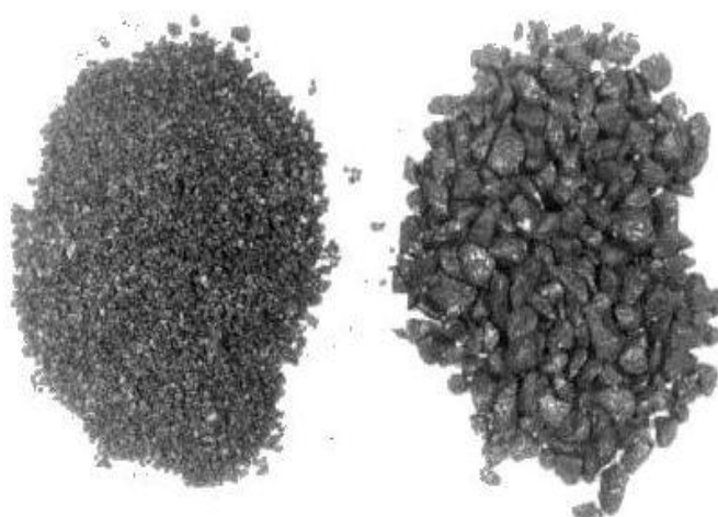
Рисунок 8 – Контрольный образец № 2 (не менее \frac{3}{4} покрытия поверхности минерального материала): слева – смеси с песком, справа – с мрамором
